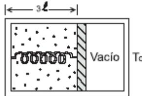
El dispositivo indicado en la figura consta de una caja dividida en dos partes por un émbolo sin fricción. En el compartimiento de la izquierda hay  $n$  moles de gas ideal y un resorte de constante  $K$  y longitud natural  $l$  que sujeta el émbolo permaneciendo elongado en equilibrio, como se muestra.
