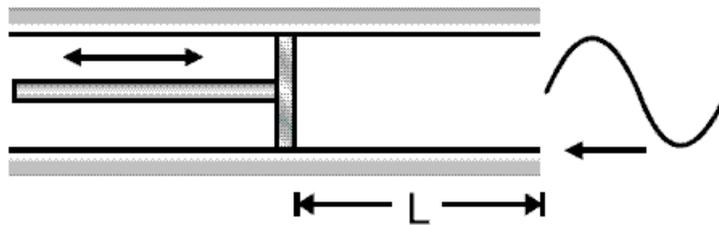
Se tiene un tubo sonoro con un extremo abierto y el otro cerrado por un pistón móvil que puede variar la longitud  $L$  como muestra la figura. Por el extremo abierto ingresa una onda sonora de frecuencia  $F$  y encontrándose que para una longitud  $L$  hay resonancia (la frecuencia  $F$  es precisamente la frecuencia del primer armónico del tubo en estas condiciones).
