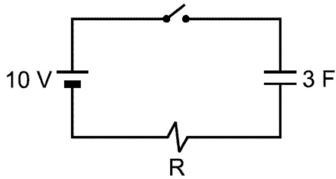
Una vez cerrado el circuito la corriente fluye. Los comportamientos de la corriente y de la caída de potencial entre las placas del condensador se muestran a continuación.
