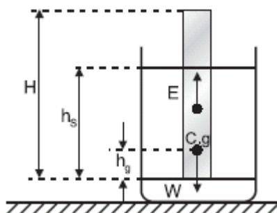
En un experimento para determinar la densidad de diferentes líquidos se usa un densímetro que es una barra cilíndrica no homogénea de longitud  $H$ , área transversal  $A$  y masa  $M$ . El centro de gravedad de la barra está a una altura  $h_g$  como se muestra en la figura. Cuando la barra flota en un líquido, el empuje está aplicado en un punto llamado centro de la flotación situado en la mitad de la altura sumergida de la barra ( $h_s/2$ )
