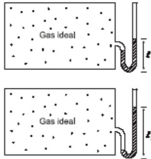
En la ciudad A, a un recipiente que contiene gas ideal se conecta un tubo en forma de U parcialmente lleno con aceite. Se observa que el aceite sube hasta el nivel L1 como se muestra en la figura. El recipiente se transporta a la ciudad B. Allí el aceite sube hasta el nivel L2 que se muestra en la figura.
